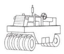
Figura 04: Rolo Pneumático
