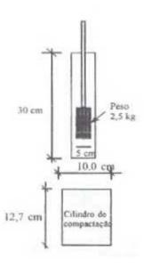
Figura 01: cilindro para ensalo de compactação
