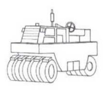
Figura 04: Rolo Pneumático
