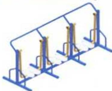
**ESQUIADOR DUPLO** - Fabricado com tubos de aço carbono de 1", 1 ¼", 2 ½" e metalon de 50x30mm, manoplas emborrachadas, pedaleira anti derrapante e pintura eletrostática de alta resistência, tampões em aço para proteção dos rolamentos, plaqueta em poliéster com especificação dos músculos trabalhados. Parafusos e porcas antioxidantes. **Tipo de Instalação:** Parabolt.
